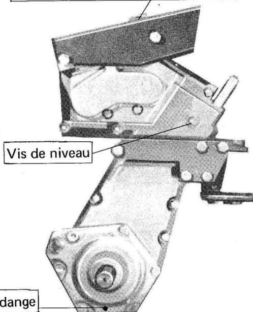
Graissage à la burette des commandes et articulations, orientation mancheron, poignée de débrayage et toutes pièces mobiles.
