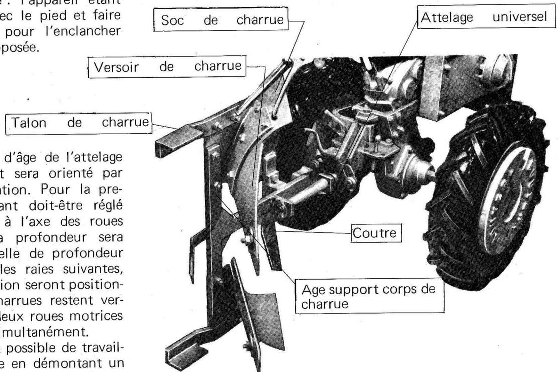
Monté sur la queue d'âge de l'attelage universel, le brabant sera orienté par les taquets d'orientation. Pour la première raie, le brabant doit être réglé perpendiculairement à l'axe des roues du motoculteur. La profondeur sera réglée par la manivelle de profondeur de l'attelage. Pour les raies suivantes, les taquets d'orientation seront positionnés pour que les charrues restent verticales bien que les deux roues motrices soient dans la raie simultanément.
