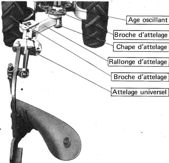
**Attelage à déport rapide :** le fonctionnement et le réglage de cet adaptation est identique à l'attelage simple.
