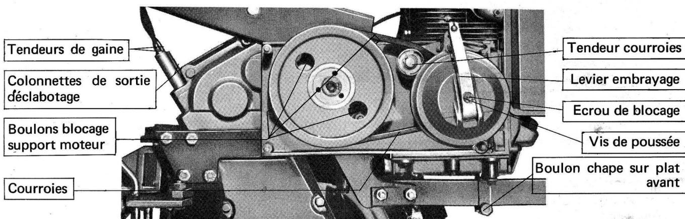
**Courroies de transmission :** La tension normale des courroies est assurée automatiquement par un tendeur à galet. Une vérification doit-être faite pour toute sécurité, toutes les 50 heures de fonctionnement de l'appareil.
