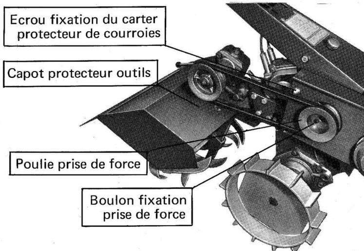
**ATTENTION :** – Remonter le nouveau carter protecteur courroie permettant le passage de la poulie prise de force : placer la cloche d'embrayage, Monter et serrer les écrous de fixation.
