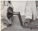
Planche 7: Bonne position pour démarrage coté volant
