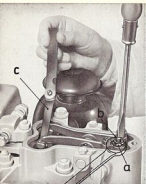
Planche 19: Vérification et réglage du jeu de soupape
