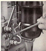
Planche 4: Purge d'air du dispositif d'injection
