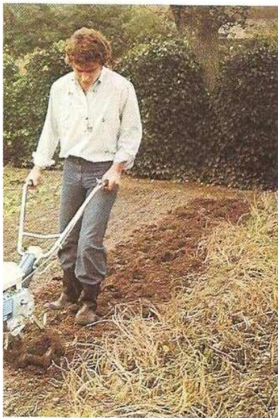
Changement de largeur sans clef ni tourne- vis. Ci-dessus : 2 étoiles pour binage étroit.
