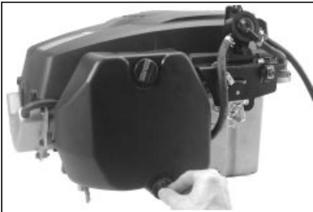
Figure 10-77. Installation du couvercle du filtre à air.
