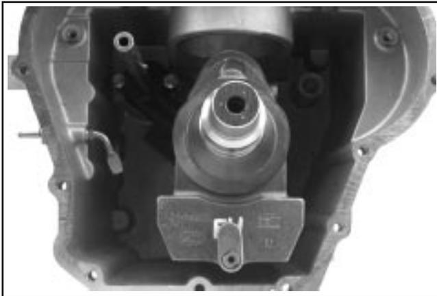
Figure 10-15. Installation du sabot de guidage.
