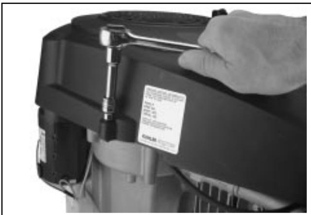
Figure 8-3. Dépose des vis du carter du ventilateur.
