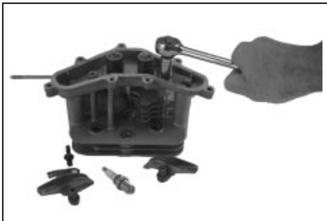
Figure 8-33. Démontage des composants du culbuteur.
