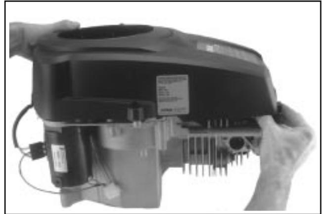
Figure 10-70. Installation du carter du ventilateur.
