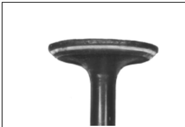
**Surchauffe :** Une soupape d'échappement soumise à une surchauffe est décolorée dans la zone au-dessus du guide. Des guides usés et des ressorts de soupape défectueux peuvent être à l'origine de la surchauffe. Contrôler également que l'admission d'air n'est pas bouchée et que les ailettes de refroidissement ne sont pas bloquées.
