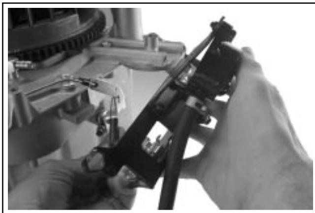
**Figure 8-17. Déconnexion du ressort du régulateur.**
