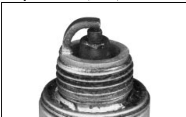
**Dépôts humides** : Une bougie humide est due à un excès de carburant ou à la présence d'huile dans la chambre de combustion. L'excès de carburant peut être provoqué par un moteur utilisé avec le starter trop ouvert ou par un filtre à air sale. La présence d'huile dans la chambre de combustion est généralement due à des segments de piston ou des guides de soupape usés.
