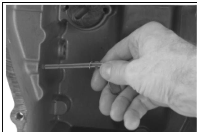
**Figure 8-53. Dépose de l'arbre intermédiaire du régulateur.**
