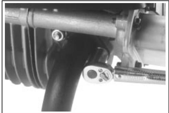
Figure 10-78. Serrage des écrous du système d'échappement.
