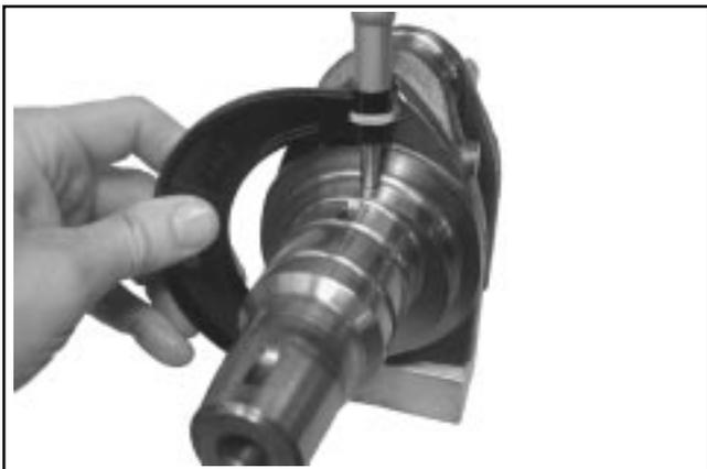
**Figure 9-5. Mesure de l'excentrique du vilebrequin.**
