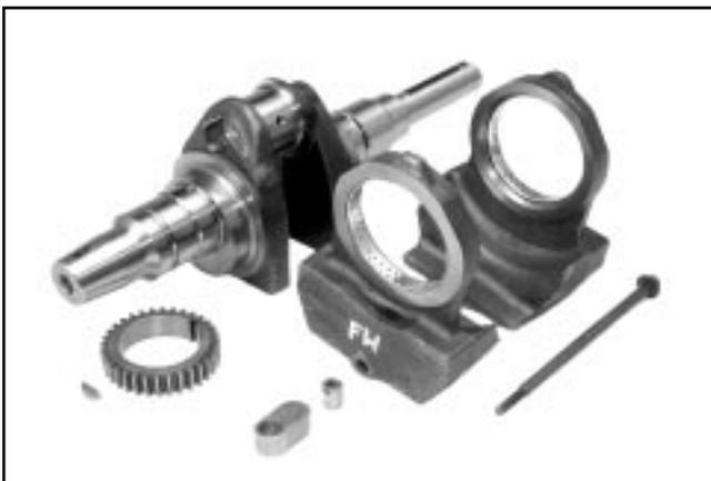
**Figure 8-51. Masses démontées.**
