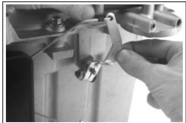
Figure 10-63. Levier du régulateur installé sur l'arbre.
