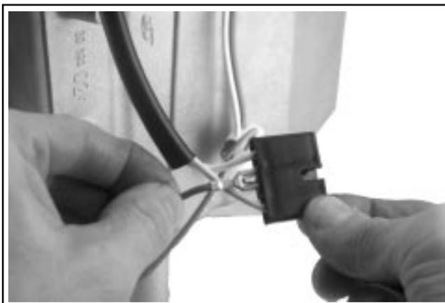
Figure 10-43. Installation du câble B+ sur le connecteur.
