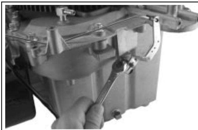
**Figure 8-18. Dépose du levier du régulateur.**
