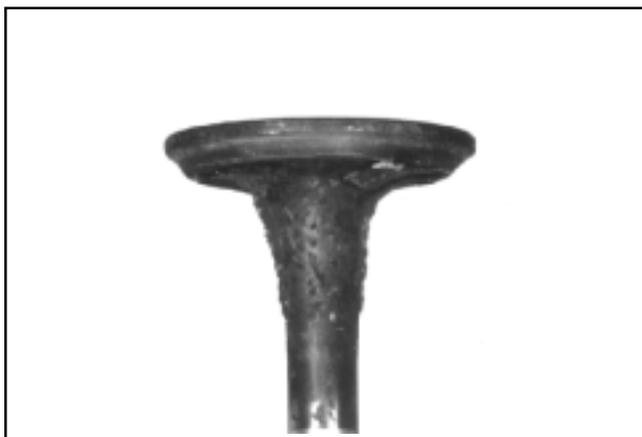
**Gomme :** Les dépôts de gomme sont généralement dus à une essence viciée. Cette situation est courante dans les équipements dont le carburant n'est pas vidé hors saison. La gomme est une des causes principales d'adhérence de soupape. La solution consiste à fraiser les guides des soupapes et à nettoyer ou remplacer les soupapes en fonction de leur état.
