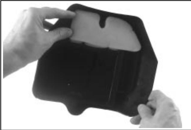
Figure 10-76. Installation du pré-filtre.
