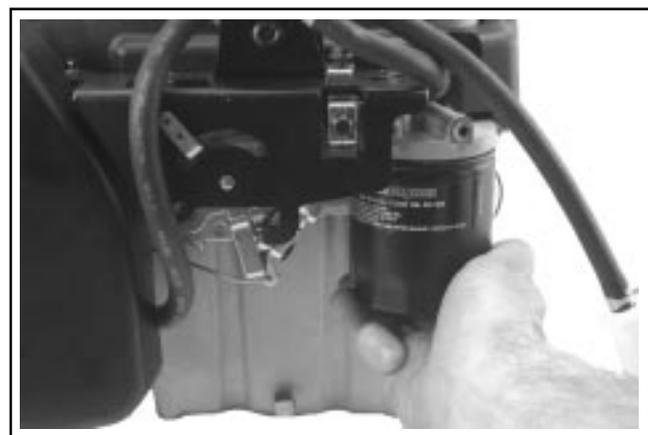
Figure 10-79. Installation du filtre à huile.
