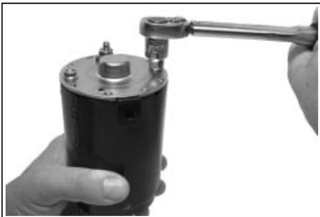
Figure 7-22. Serrage des boulons.
