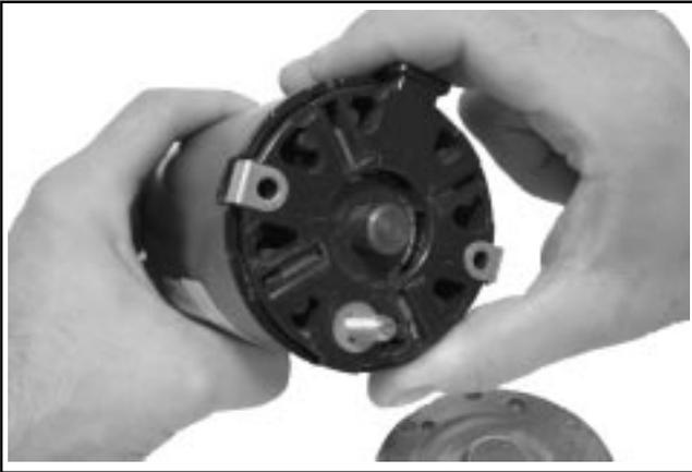
**Figure 7-17. Dépose du support de balais.**
