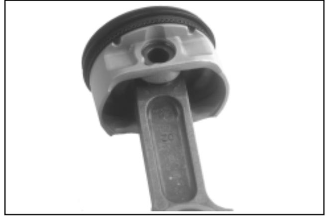
Figure 10-16. Assemblage du piston et de la bielle.
