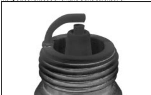
**Dépôts de carbone** : Des dépôts de suie noirs indiquent une mauvaise combustion. Une mauvaise combustion est généralement causée par une carburation trop riche, un allumage faible ou une compression pauvre.
