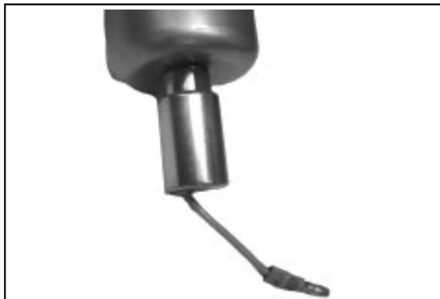
**Figure 5-11. Solénoïde d'arrêt du carburant.**
