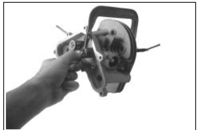
Figure 10-32. Assemblage de la culasse.
