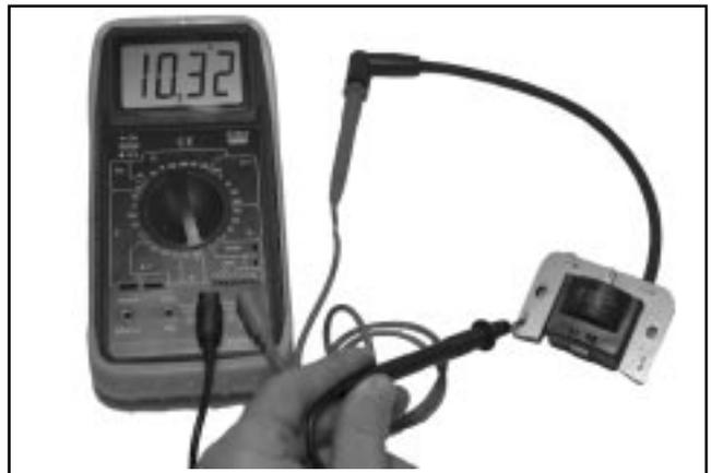
**Figure 7-5. Essai de l'enroulement secondaire du module d'allumage à décharge capacitive.**
