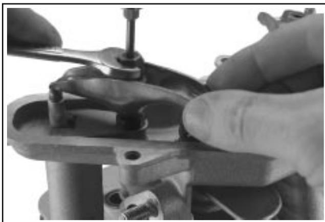
Figure 8-28. Desserrage des vis et écrous de réglage.
