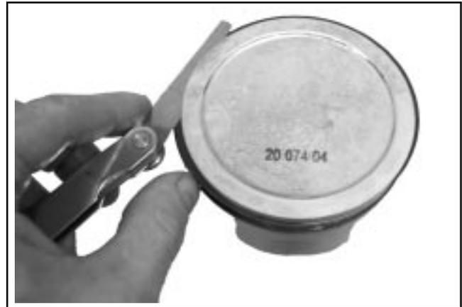
**Figure 9-14. Mesure du jeu latéral du segment de piston.**
