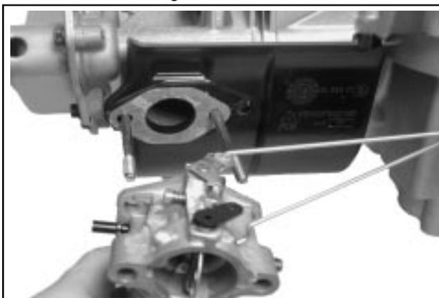
Figure 8-15. Dépose du carburateur.
