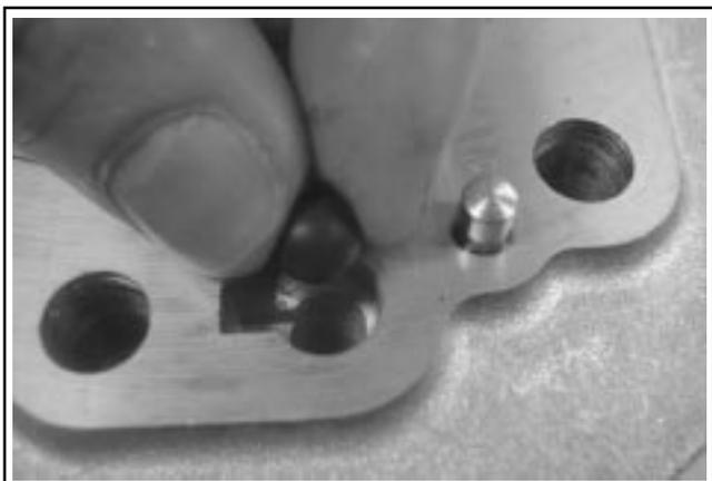
Figure 10-33. Installation du drain.
