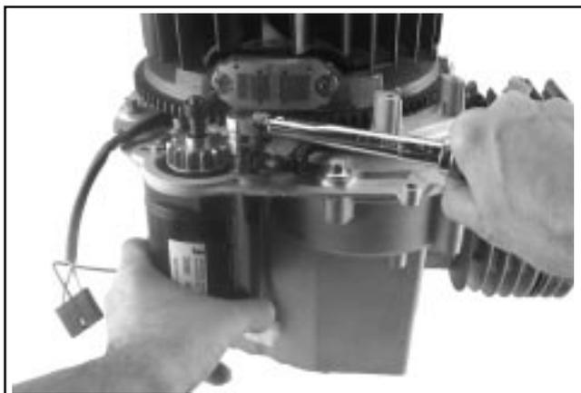
Figure 10-47. Installation du démarreur électrique.
