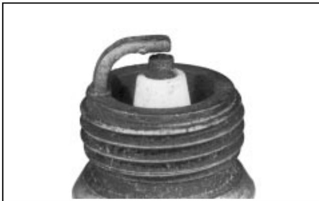
**Dépôts calcaires blancs** : Des dépôts calcaires blancs indiquent une surchauffe. Cette situation est généralement accompagnée d'une érosion excessive de l'écartement. Le colmatage de la grille de protection contre l'herbe ou des ailettes de refroidissement ainsi qu'une carburation maigre peuvent être à l'origine d'une surchauffe.
