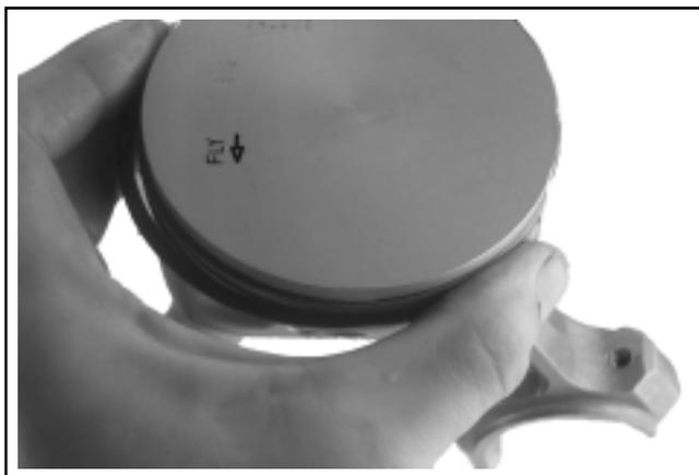
Figure 10-17. Flèche de direction sur le piston.
