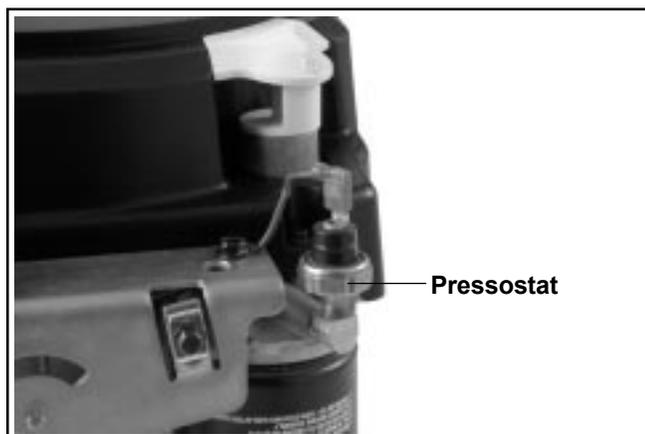
**Figure 6-9. Emplacement du pressostat Oil Sentry™.**
