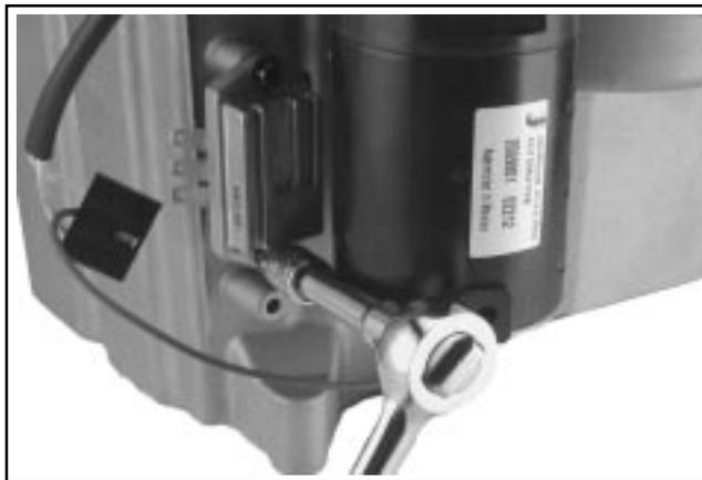
Figure 8-5. Dépose du redresseur-régulateur.
