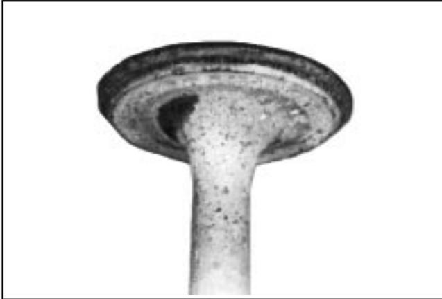
**Normale** : Après de longues heures de fonctionnement, une soupape peut être reconditionnée et réutilisée si le collet et la marge sont encore en bon état. Si la soupape est usée à une marge inférieure à 1/32", ne pas la réutiliser. La soupape montrée ici a été en service pendant presque 1000 heures dans des conditions de test contrôlées.
