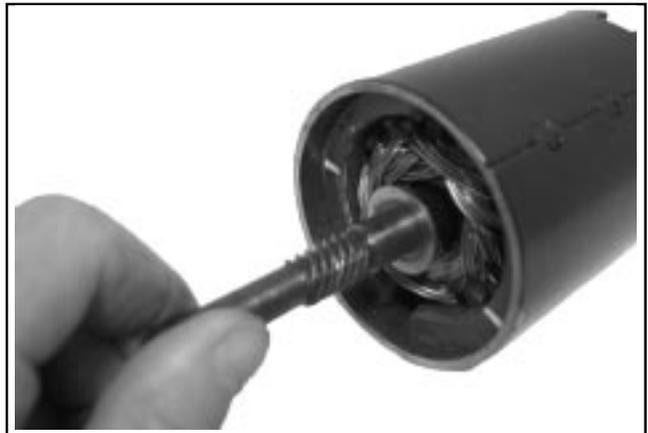
**Figure 7-19. Armature installée dans le corps de démarreur.**
