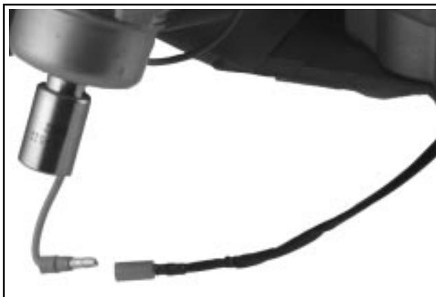
Figure 8-14. Débranchement du solénoïde d'arrêt du carburant.
