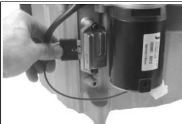
Figure 10-69. Installation du redresseur-régulateur.
