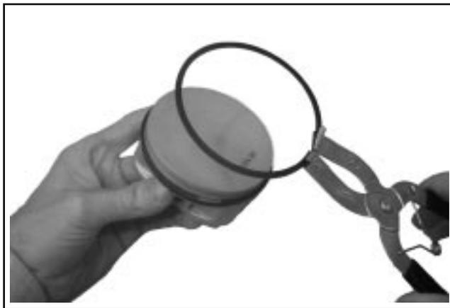
Figure 8-47. Dépose des segments de piston.
