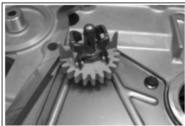
Figure 5-20. Réducteur du régulateur/Unité centrifuge.
