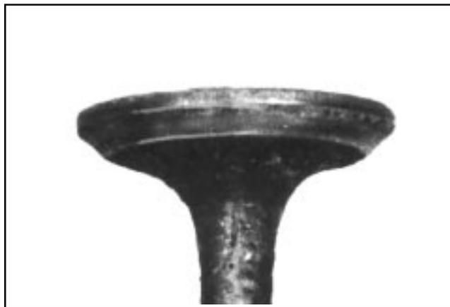
**Corrosion de la tige :** L'humidité dans le carburant ou la condensation sont les causes les plus courantes de corrosion de la tige. La condensation provient d'une conservation incorrecte durant le remisage. Elle peut aussi être provoquée par des arrêts répétés du moteur avant qu'il ait la possibilité d'atteindre des températures de fonctionnement normales. Remplacer les soupapes corrodées.
