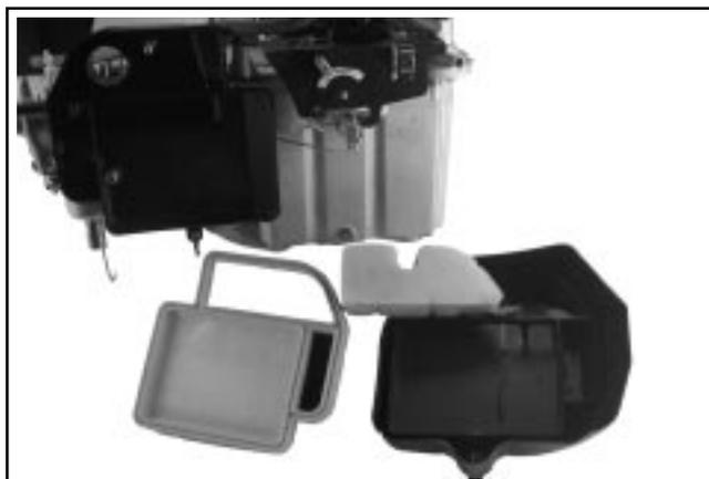
Figure 8-8. Dépose des composants du filtre à air.
