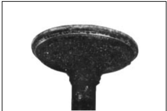
**Traces de chauffe** : Les traces de chauffe sur les soupapes d'admission sont normales et ne sont pas dangereuses. Si le siège est en bon état, la soupape peut être réutilisée après avoir été nettoyée.
