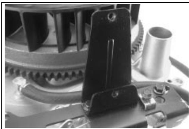
Figure 10-67. Installation de la console de montage de la pompe à carburant.
