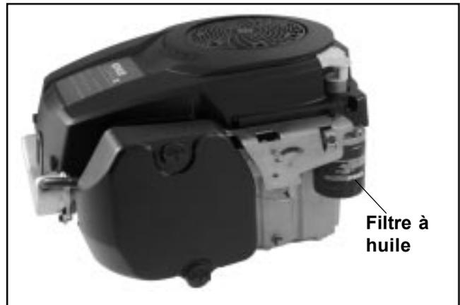
Figure 6-8. Emplacement du filtre à huile.
