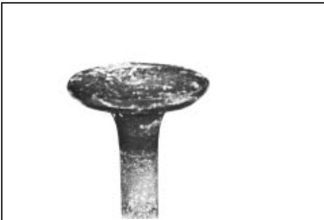
**Mauvaise condition** : La soupape montrée ici doit être remplacée. Noter la tête abîmée, la marge abîmée et trop étroite. Ces défauts peuvent être attribués à un fonctionnement trop intensif ou à de mauvaises conditions de fonctionnement.
