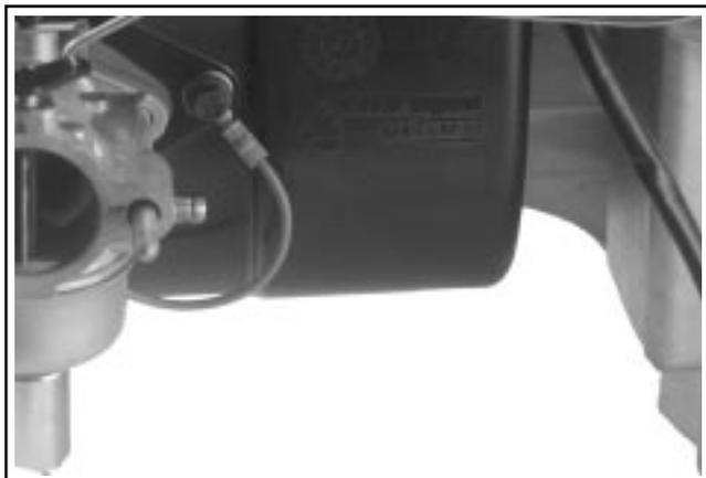
Figure 10-56. Mise en place du conducteur de masse.
