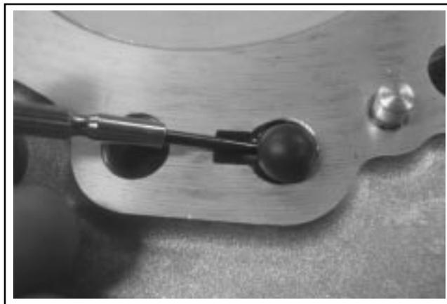
Figure 8-31. Dépose du drain du carter.
