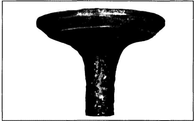
Corrosion de la tige : L'humidité provenant du carburant ou de la condensation sont les causes les plus courantes de corrosion de la tige de soupape. La condensation se produit suite à une mauvaise conservation pendant le stockage et lorsque le moteur est arrêté à plusieurs reprises avant qu'il n'ait eu la chance d'atteindre les températures normales de fonctionnement. Remplacez les vannes corrodées.
