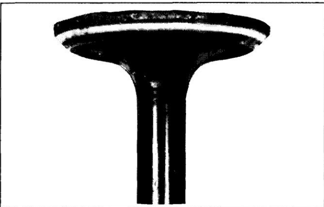
Surchauffe : Une soupape d'échappement sujette à une surchauffe présentera une décoloration sombre dans la zone située au-dessus du guide de soupape. Des guides usés et des ressorts de soupape défectueux peuvent provoquer cette condition. Vérifiez également l'admission d'air obstruée, les ailettes bloquées et le mélange de carburant pauvre lorsque cette condition est constatée.
