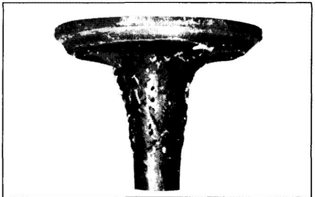
Gomme : Les dépôts de gomme résultent généralement de l'utilisation d'essence périmée. Cette condition est souvent constatée dans les applications où le carburant n'est pas vidé du réservoir hors saison. La gomme est une cause fréquente de grippage des valves. Le remède consiste à aléser les guides de soupapes et à nettoyer ou remplacer les soupapes, en fonction de leur état.
