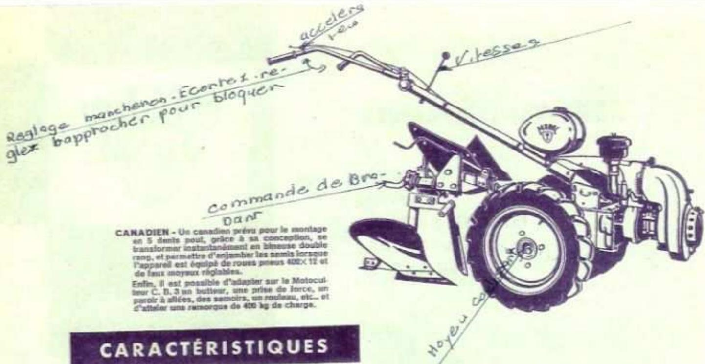
**CANADIEN** - Un canadien prévu pour le montage en 5 minutes peut, grâce à sa conception, se transformer instantanément en bineuse double rang, et permettre d'enjamber les semailles lorsque l'appareil est équipé de roues pneus 400x12 et de faux moyeux réglables.
