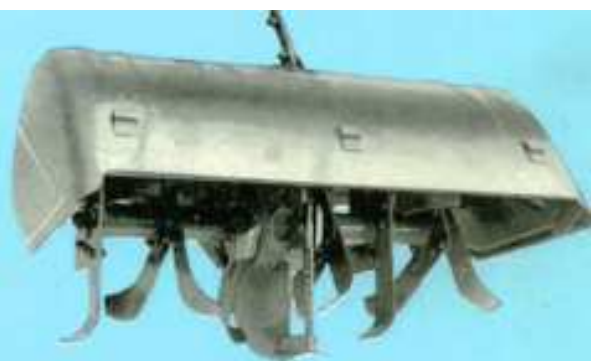
ROTOCULTEUR. Largeur : 0 m 60
