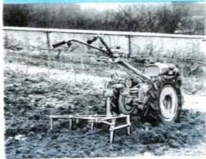
Moteur monocylindrique BERNARD W 239 Locomotion - 4 temps Alésage 62 - Course 60 - Cylindrée 181 cc. Puissance 5 ch - Consommation 0,8 litre Graissage par barbotage Refroidissement par air soufflé Régulateur centrifuge Allumage par volant magnétique Filtre à air à bain d'hoile Carburateur tous terrains
