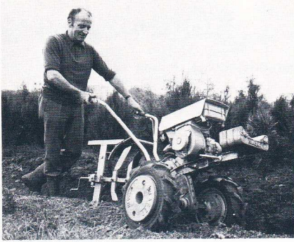
Labour avec brabant 1/2 tour à réglages d'aplomb et de profondeur incorporés.
