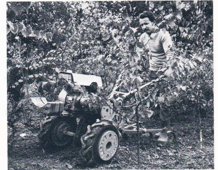
Utilisation en canadien, mais le porte-outils peut aussi recevoir une herse, une bineuse, un butteur, etc.
