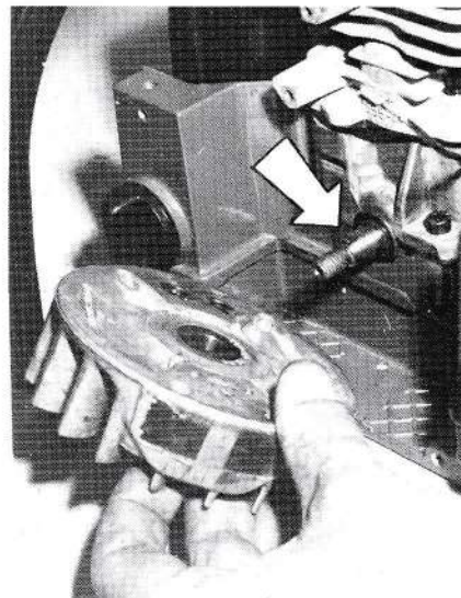
Repose du volant magnétique, rainure face à la clavette (flèche).
