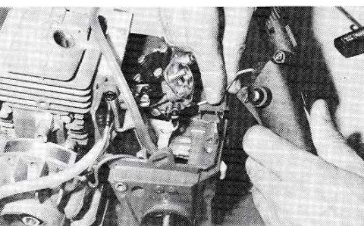
Dépose de la tringle de la gâchette d'accélérateur.
