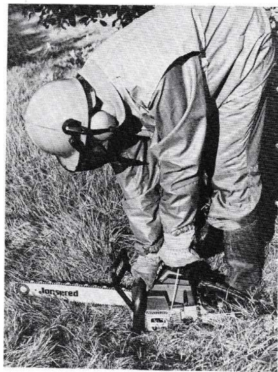
Equipement complet et démarrage au sol sur une machine prévue pour démarrer avec le frein de chaîne serré. Sécurité absolue (voir texte « démarrage » page suivante).
