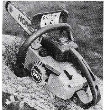
5. Plus rare est la suspension de la poignée par le dessus du corps de la machine.
