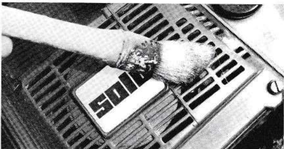
Dépose du filtre à air pour nettoyage. Grille de prise d'air (ventilateur).
