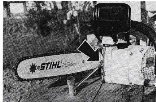
2. La solution la plus fréquente pour la tension de la chaîne, mais pas la plus pratique.
