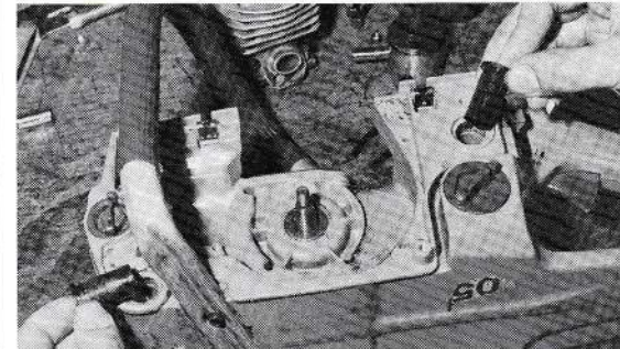
Séparation du carter moteur et de la poignée arrière réservoir.
