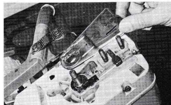
Dépose de la plaque de protection de pompe à huile.
