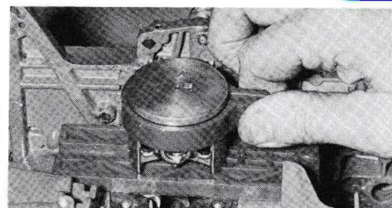
Mise en place du collier de serrage des segments de piston.
