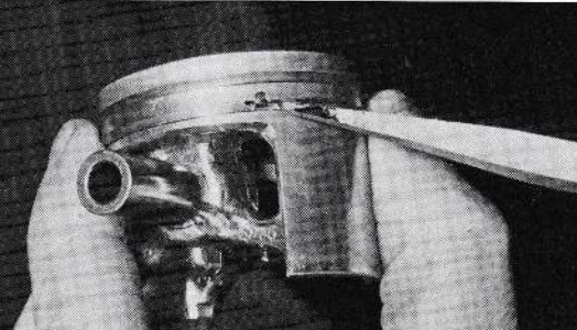
Mise en place des segments sur ergot de piston.
