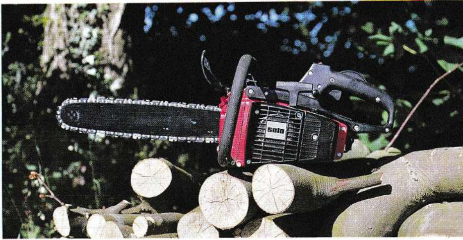
Deux types de machines à cylindres horizontaux. Ci-dessus, la poignée a été disposée en porte-à-faux au-dessus du cylindre facilitant ainsi les travaux de tronçonnage de bûches sur chevalet.
