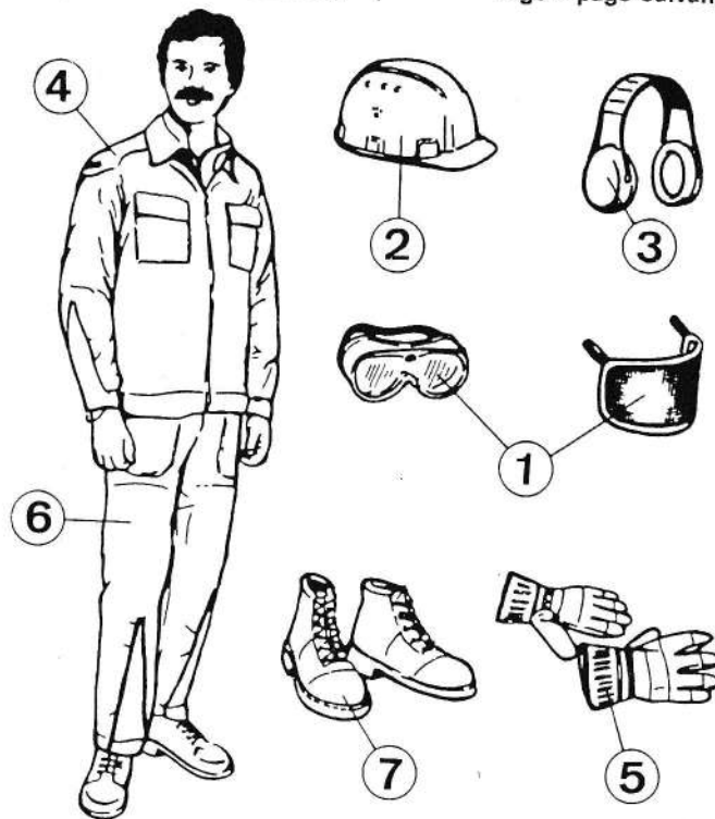
Equipement complet et démarrage au sol sur une machine prévue pour démarrer avec le frein de chaîne serré. Sécurité absolue (voir texte « démarrage » page suivante).
