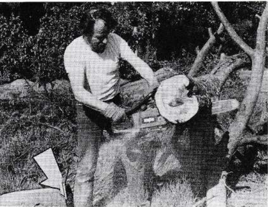
ATTENTION DANGER En se détachant le tronçon va tomber sur les pieds de l'utilisateur, de plus le tronçon précédent (flèche) va lui faire perdre l'équilibre.
