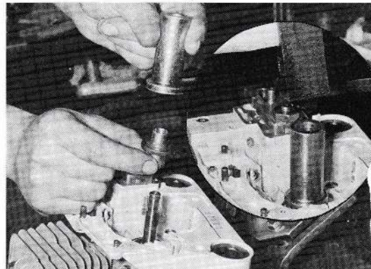
Mise en place de la bague d'étanchéité côté embrayage (1 re phase, à gauche) ; pose définitive (2 e phase, à droite).
