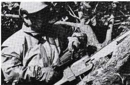
Exemple de coupe dans les fibres en compression. La branche, retenue à son extrémité, est sous tension.
