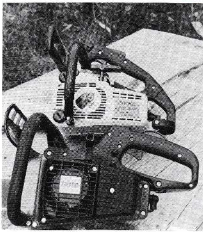
1. En haut : poignée d'élagueuse sur le dessus pouvant se tenir d'une main. En-dessous : poignée en porte-à-faux étudiée pour le tronçonnage sur chevalet.
