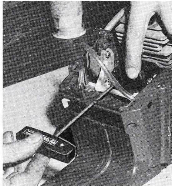
Dépose de la pipe d'admission (clé en « T » vis six pans creux).
