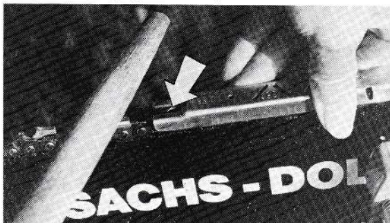
Rectification du limiteur de copeaux (voir texte page suivante).
