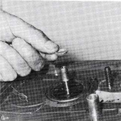
Dépose de la deuxième bague feutre.
