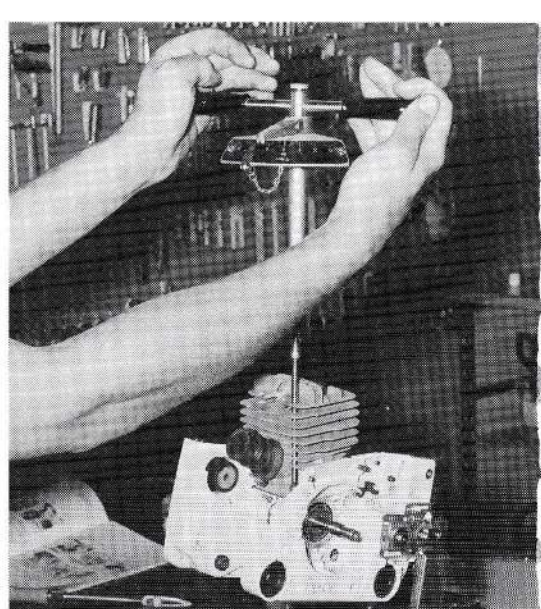
Serrage des vis de fixation du cylindre à l'aide de la clé dynamométrique.
