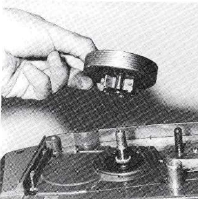
Dépose (ou pose) de la cloche d'embrayage. La première rondelle feutre et le roulement à aiguille sont restés dans la cloche.
