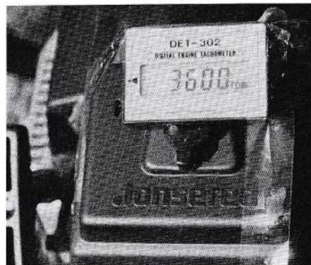
6. Contrôle du régime d'embrayage (entraînement de la chaîne - exemple JONSERED).
