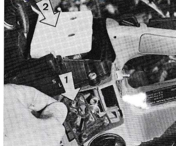
9. Pratiquement toute la gamme Sachs-Dolmar est équipée du même préfiltre disposé sur le flanc.
