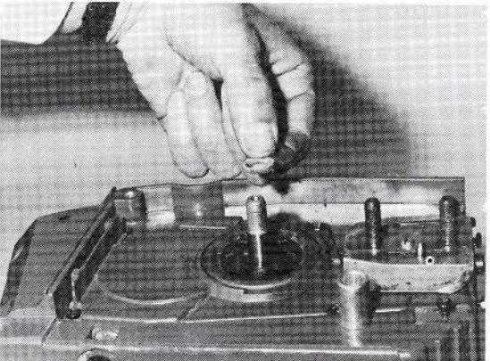
Mettez des rondelles feutres neuves avant la repose de la cloche d'embrayage.
