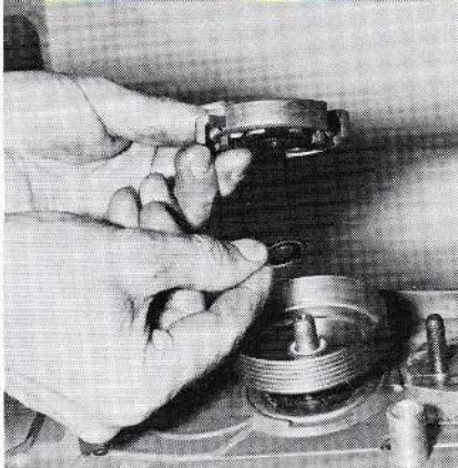
Remise en place de l'embrayage centrifuge.
