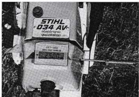
5. Contrôle du ralenti à 2500 tr/mn (exemple STIHL).
