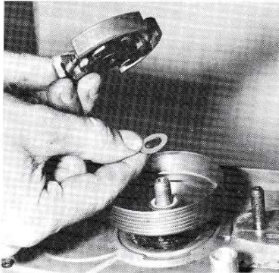
Dépose (ou pose) de l'embrayage centrifuge et de la rondelle. -
