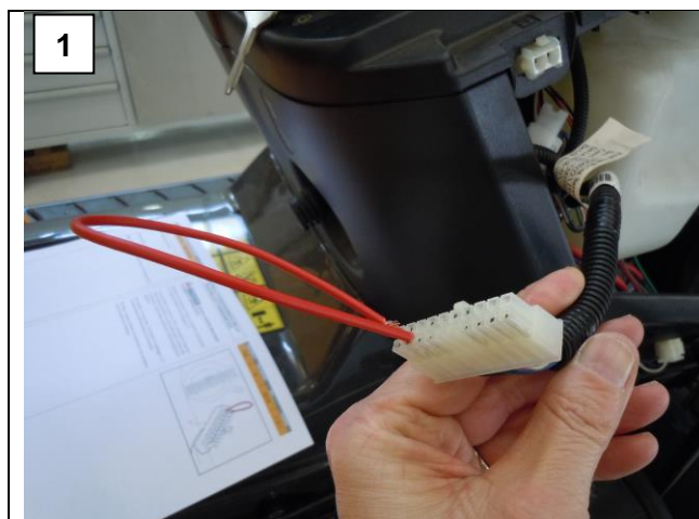
1 Pont entre 2 et 11
